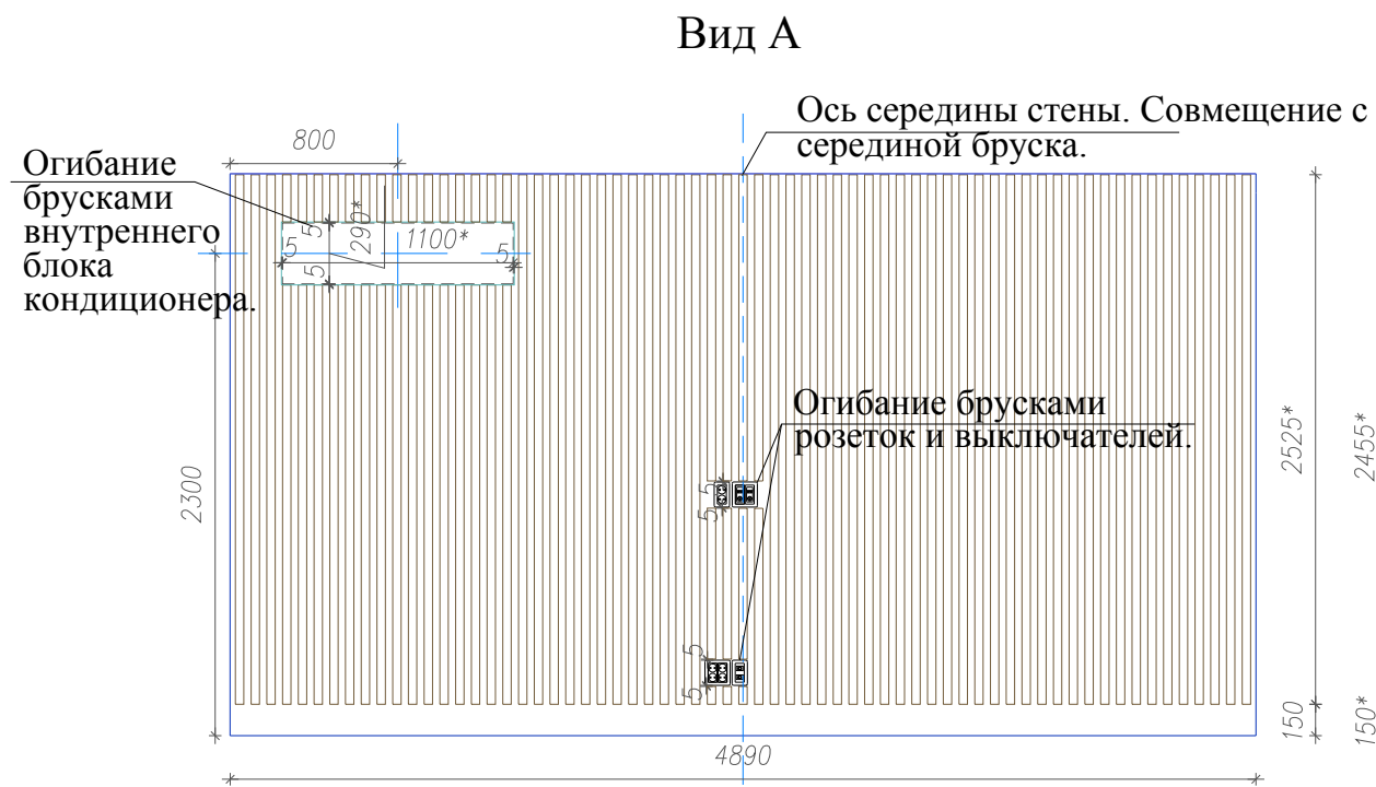
План конструкции из деревянных брусков
